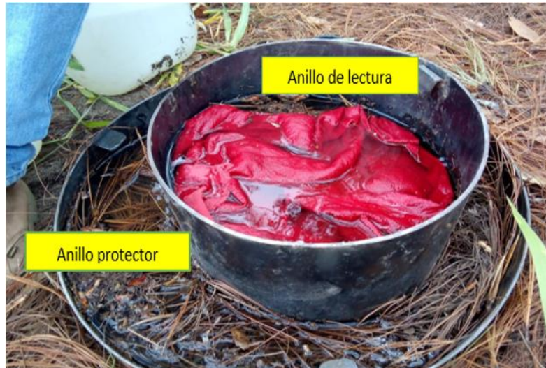
Figura 2. Anillos concéntricos para estimar capacidad de infiltración.
